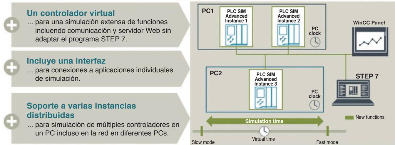
PLCSIM Advanced es una herramienta completa de simulación que le permite no sólo simular en tiempo real el funcionamiento de un controlador, ej.: S7-1500, sino varias CPUs, así como la comunicación entre éstas.
